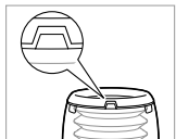
AFBEELDING 15 Houd de behuizing met de opening omhoog en breng de vouwbalg aan. Let daarbij op een correcte zitting van de vouwbalg.
